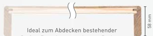
Ideal zum Abdecken bestehender Stufen, Besteht aus mehreren Parkett-Stäben\* und schließt an den Längsseiten jeweils mit einer Multileiste ab. Pro Großformatplatte können **zwei Trittstufen** gefertigt werden.
