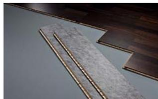
Besonders empfehlenswert ist unsere werksseitige Kaschierung der Dämmunterlage auf der Dielenrückseite (ab einer Menge von 10 qm). Aufgrund der festen Verbindung zwischen Parkettdiele und Dämmung wird eine Beeinträchtigung der Dämmwirkung durch Hohlstellen und Luftbrücken vermieden. Weiterer Vorteil: Verlegung und Dämmung erfolgen in nur einem Arbeitsschritt.
