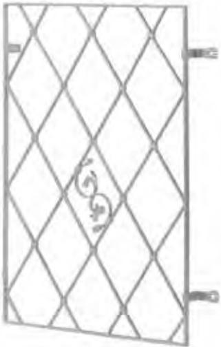
**Montagehinweis:** Bei Montage des Fenstergitters auf der Außenwand muss das Fenstergitter mindestens so breit sein, dass die Befestigungsbohrungen 80 mm von der Fensterlaibung entfernt sind, sonst besteht die Gefahr, dass das Mauerwerk ausbricht.
