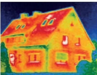
Wärmeverluste eines Hauses (in Rot). Der U-Wert (früher k-Wert) ist das Maß für den Wärmedurchgang. Je kleiner er ist, desto besser. Zeitgemäße Dächer weisen einen U-Wert von max 0,20 W/m<sup>2</sup>K oder niedriger auf.
