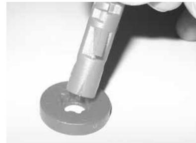
7. Die Kunststoffdistanzscheibe auf den Dübel stecken und in die Bohrlöcher setzen.
