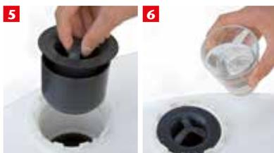
Der Geruchsverschluss kann separat bestellt werden. Beim Rückstauverschluss ist er im Lieferumfang enthalten und zwingend erforderlich. Den Geruchsverschluss eindrücken, bis die Dichtlippe arretiert. Anschließend mit Wasser befüllen
