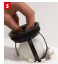
Die Rückstau-einheit von oben in den Grundkörper führen. Beim Einschrauben auf den korrekten Sitz des Gewindes achten. Drehmoment: 5 Nm
