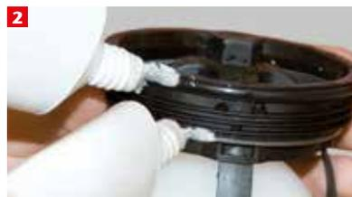
Die Rückstau-einheit kann separat bestellt werden (beim Rückstauverschluss im Lieferumfang enthalten). Vor dem Einsetzen den O-Ring und die Dichtlippe dünn mit Gleitmittel bestreichen.
