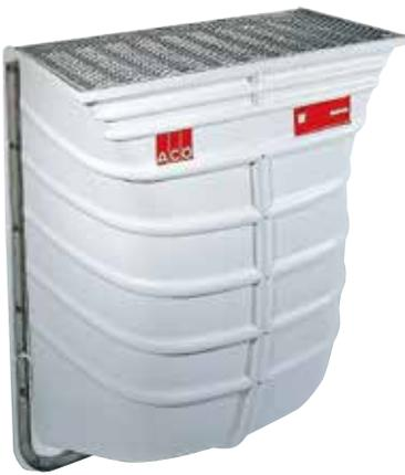
ACO Lichtschacht aus Polypropylen (PP) mit druckwasserdichtem Anschluss in den Größen: 100 x 130 x 50 cm und 125 x 130 x 60 cm (Zubehör erforderlich!)
