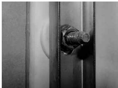
den Seiten hervorquillt – möglichst mit einem Drehmomentschlüssel (30 Nm). Wenn kein Drehmomentschlüssel zur Verfügung steht, ziehen Sie die Schrauben mit einer handelsüblichen Knarre handfest an.
